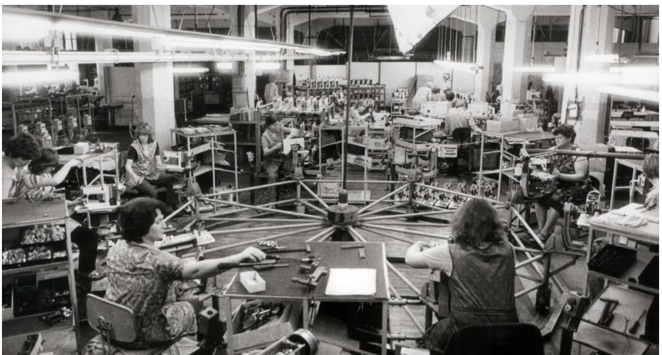
Zu DDR-Zeiten waren im Wittenberger Nähmaschinenwerk bis zu 3200 Mitarbeiter beschäftigt. Hier das Rundband in der Montage.
